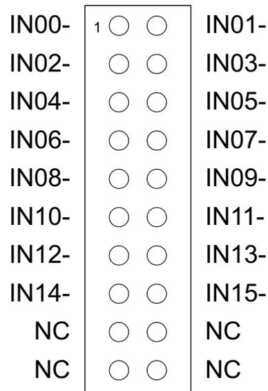
Die Anschlussstecker CNB2 und CNB3 dienen zum Durchschleifen der Steuersignale auf ein mögliches weiteres XMOD-SSR-2 Modul. Das mitgelieferte 20pol. Flachbandkabel ist hierfür zu verwenden!
