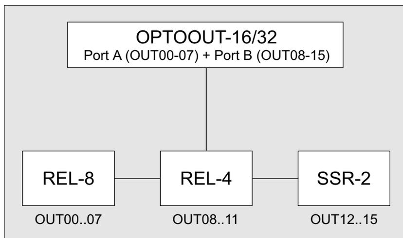
Die Zuordnung Steuerkanal/Schaltausgang ist - in Grenzen - frei wählbar (siehe Steuerung durch OPTOIO-8 oder durch eine **wasco**<sup>®</sup>-PC-Interfacekarte).
