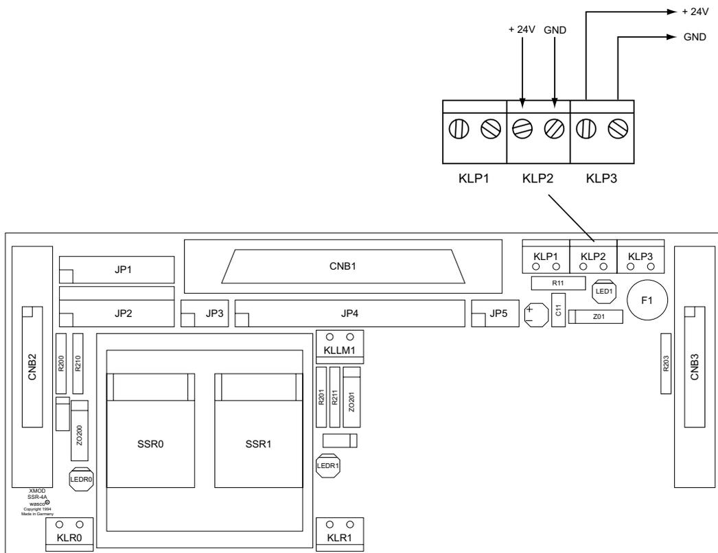
Schließen Sie die Lastkreise gemäß der Abb. an die Klemmenpaare KLR0 bis KLR3 an. Achten Sie bei allen Leiteranschlüssen auf die nötige Zugfreiheit.
