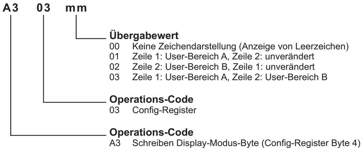
Im Display-CLR-Modus-Byte wird festgelegt, welche Daten am Display im Blink- bzw. Wechsel-Anzeige-Modus abwechselnd zur Kommunikations- bzw. Refresh-Anzeige dargestellt werden.
