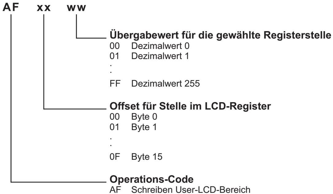
Der User-LCD-Bereich umfasst 16 Stellen (16 Byte), der Bereich wird byteweise beschrieben.
