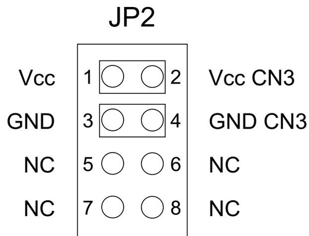
Durch Setzen der Jumper JP2/1-2 und 3-4 kann die interne Versorgungsspannung (+ 5V), sowie die Masse des Rechners auf die SCSI-II Buchse CN3 gelegt werden.
