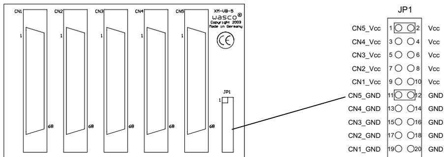
Über JP1 am KM-VB-5 besteht die Möglichkeit die Versorgungsspannung +5V und GND von der PCI-Karte auf die Anschlussbuchsen CN1... CN5 zu legen.
