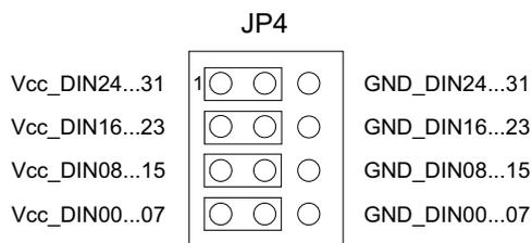
Um evtl. auftretende Störsignale auf den Datenleitungen DINxx reduzieren zu können, besteht die Möglichkeit, über JP4 die Datenleitungen über optional einsetzbare Abschlusswiderstände (Widerstandsdekaden RAUD1...RAUD4) blockweise auf +5V oder GND zu legen.
