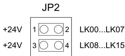
Über JP2 werden die Status-LEDs LK00...LK15 mit Spannung versorgt und können durch Entfernen der Jumperbrücken an JP2 abgeschaltet werden.
