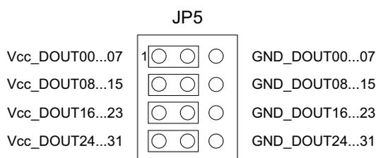
Um evtl. auftretende Störsignale auf den Datenleitungen DOUTxx reduzieren zu können, besteht die Möglichkeit, über JP5 die Datenleitungen über optional einsetzbare Abschlusswiderstände (Widerstandsdekaden RAUD5...RAUD8) blockweise auf +5V oder GND zu legen.
