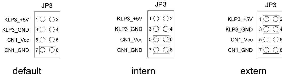
Über JP3 erfolgt die Verbindung der Masse (GND) der **wasco**®-Karte mit der Masse (GND) des KM-Moduls. Der Jumper 7-8 an JP3 muss daher immer gesetzt sein.
