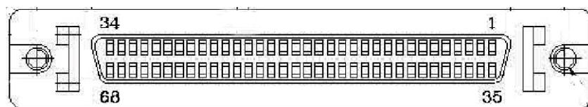
Achtung: der Stecker ist auf der Platine um 180° gedreht montiert (Pin1 links unten)
