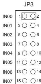
Durch das Setzen eines Jumpers zwischen Pin1 und Pin2 des Jumperblocks JP3 wechselt der Eingangsspannungsbereich des IN00 von 0..2V (Low) und 14..30V (High) auf 0..1V (Low) und 5..15V (High). Die restlichen Eingangsspannungsbereiche bleiben unverändert.
