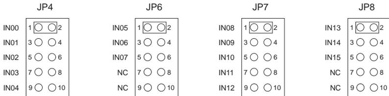
Durch das Setzen eines Jumpers zwischen Pin1 und Pin2 des Jumperblocks JP4 wechselt der Eingangsspannungsbereich des IN00 von 0..2V (Low) und 14..30V (High) auf 0..1V (Low) und 5..15V (High). Die restlichen Eingangsspannungsbereiche bleiben unverändert.
